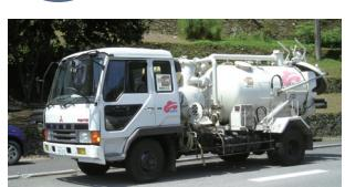
屋根工事専用屋根土吸引車両「クリーンカー」で古い屋根土から天井裏に落ちた土ほこりまで吸引除去。
